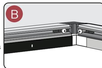
B - Encaixar o perfil lateral na parte dianteira e apertar os parafusos das cantoneiras.
