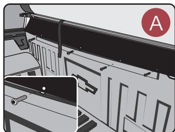
A - Para fixar a parte dianteira, retirar parafusos originais e encaixar a chapa de aço entre o protetor e a caçamba, utilizar os mesmos parafusos para prendê-la.
