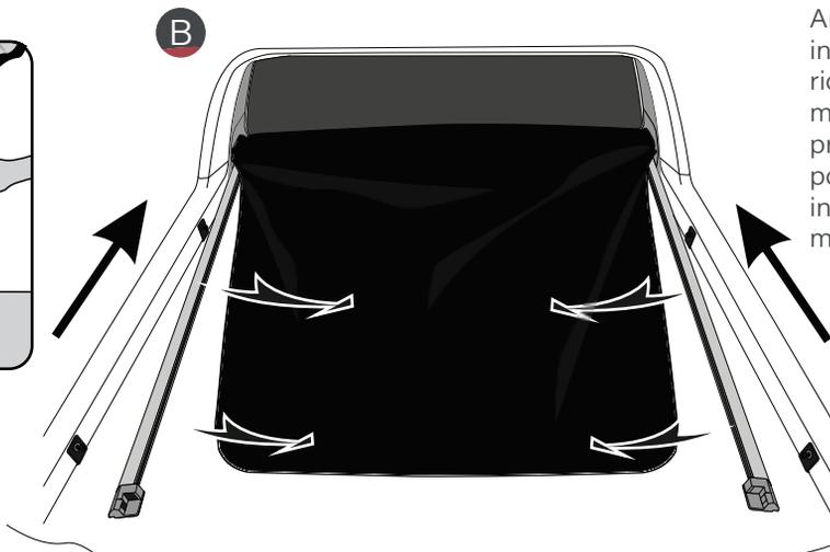
Antes de finalizar a instalação é necessário encaixar a parte menor do flex lateral próximo à dianteira, pois após a capota instalada, não será mais aberta.
