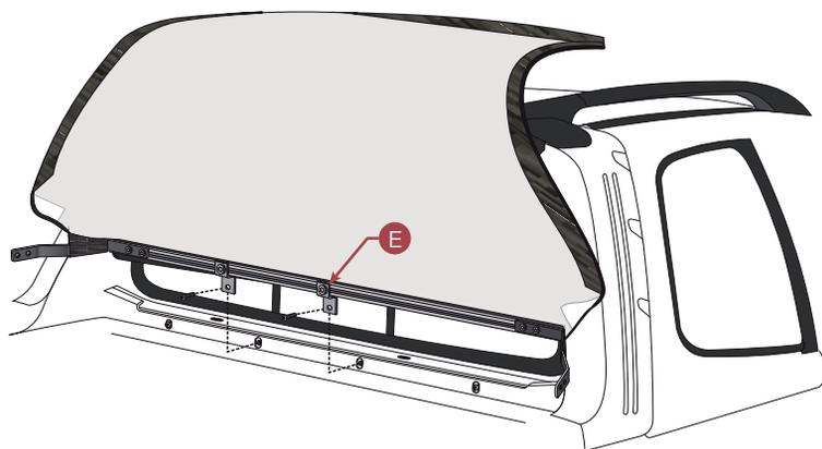
Fixar o perfil dianteiro utilizando o suporte dianteiro (E).
