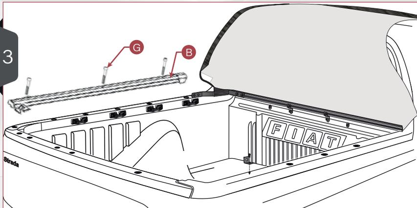
Fixar perfil lateral (B), utilizando parafusos (G), alinhando com a furação original da caçamba.
