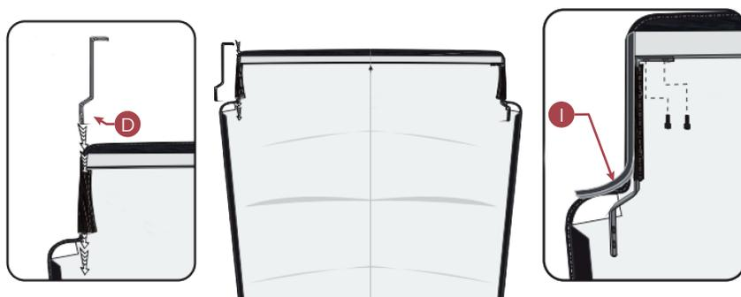
Montar o suporte de fixação lateral + frente (D) na lona. Introduzir o suporte de fixação (D) no bolso da capota, fixando no perfil dianteiro, utilizando os parafusos que já estão nas barras. Colar borracha de vedação (I) pressionando contra a cabine para dar boa vedação.
