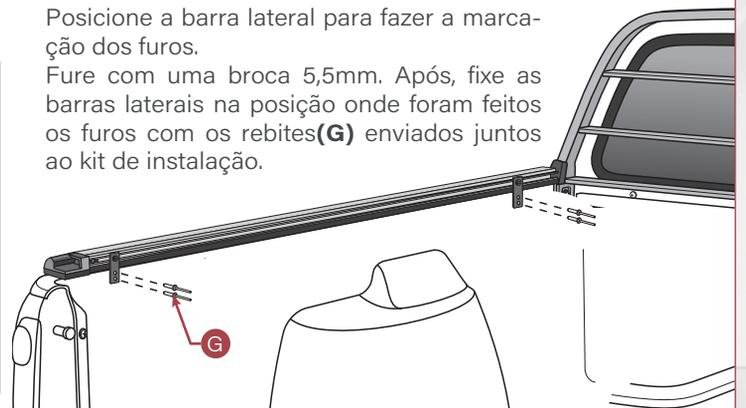
3 Para instalação em veículos com ganchos, recorte a borracha grossa que está em baixo da barra lateral para fazer uma "casinha" para o gancho da pick up.
