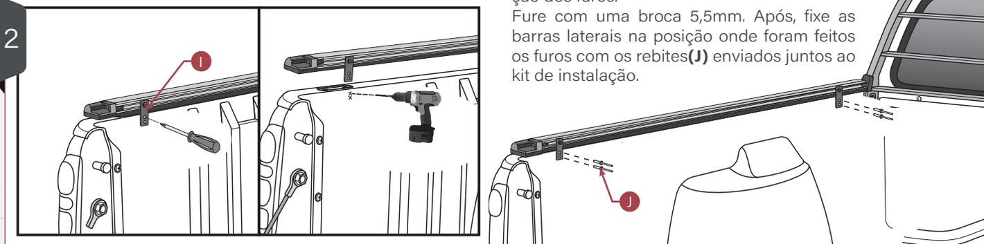
Posicione a lona(A) sobre o veículo. Para melhor instalação encaixe as laterais conforme imagem(1) prenda o suporte lateral + frente(H) com os parafusos e arruelas que estão na barra.
