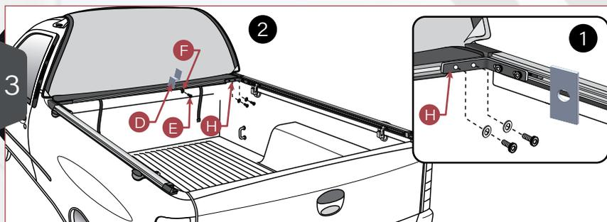
Verifique os extensores(C) colocando o maior mais próximo a cabine e o menor na parte traseira. Encaixar lâmina plástica abaulada para um perfeito acabamento.
