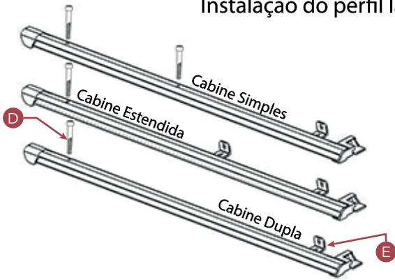
**2 Fixação dos suportes do perfil lateral**
