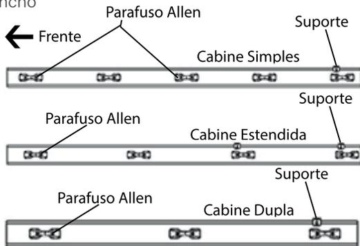
Obs: Retire os ganchos originais e instale conforme o desenho.
