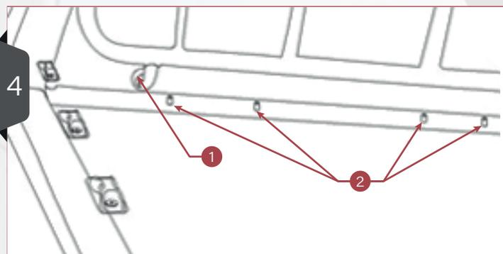
**Fixação do perfil dianteiro na cabine simples**
